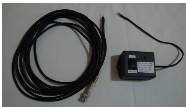
Figura 24 - Cabo com sensor infravermelho e circuito para ser acoplado à massa de impacto
