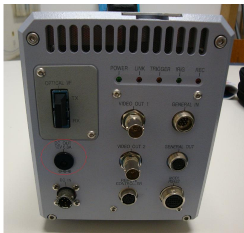
Figura 21 - Painel da câmera e saída DC 12 V
