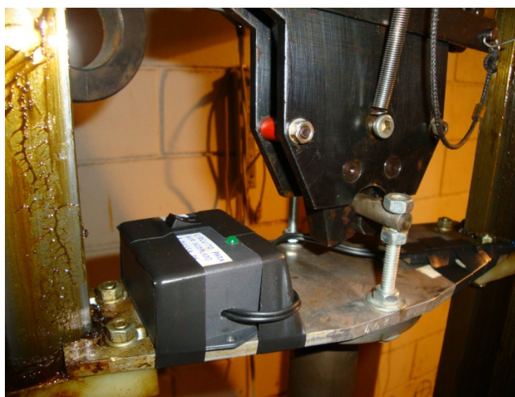
Figura 48 - Parte embarcada do sensor infravermelho fixado no martelo
