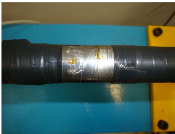
Figura 18 - Extensômetro colado na barra
