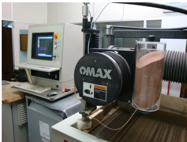
Figura 7 - Máquina de corte a água do Laboratório de Mecânica de Rochas
